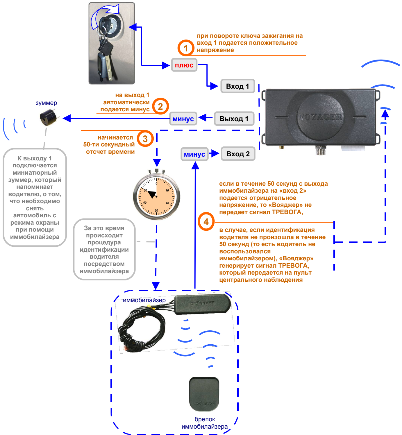
Рис. 10.3. Алгоритм работы «Вояджера» во втором режиме по входам 1 и 2.
