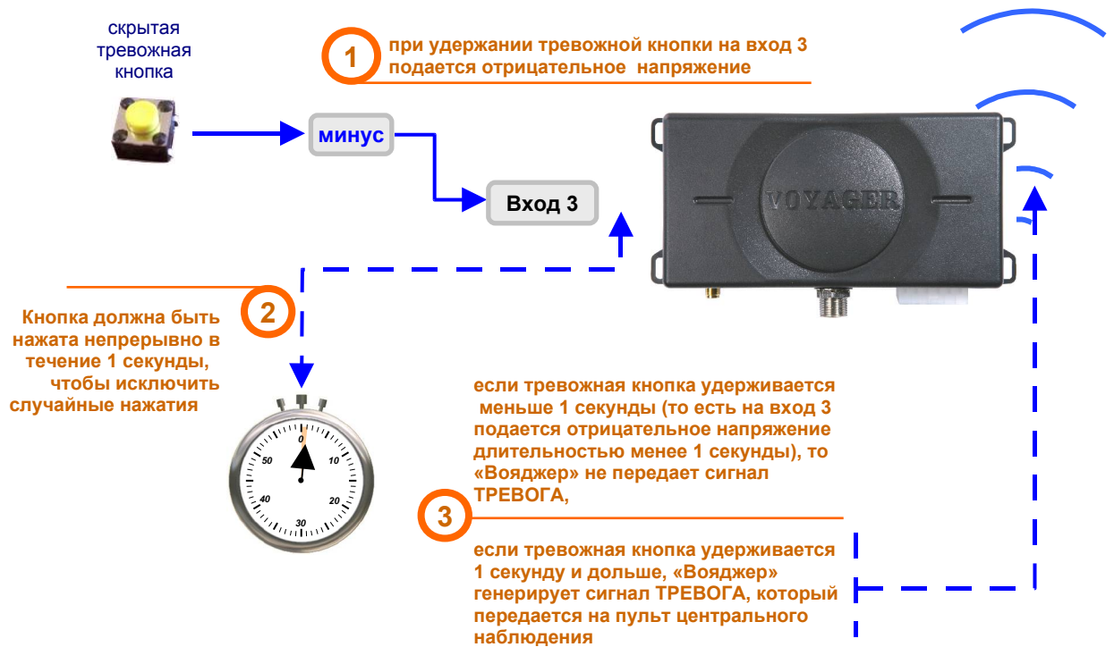
Рис.10.4. Алгоритм работы «Вояджера» во втором режиме по входу 3.
