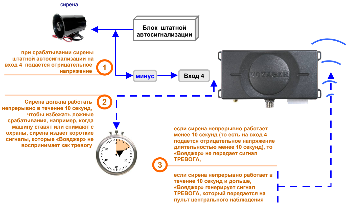
Рис.10.5. Алгоритм работы «Вояджера» во втором режиме по входу 4.
